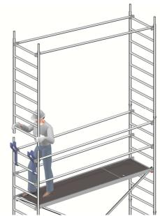
2. Sollevare il telaio, con i correnti ad esso collegati, e assemblarlo al telaio sottostante
