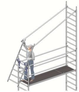
1. Agganciare l'accessorio di montaggio al telaio, posizionare il telaio successivo e agganciare i correnti
